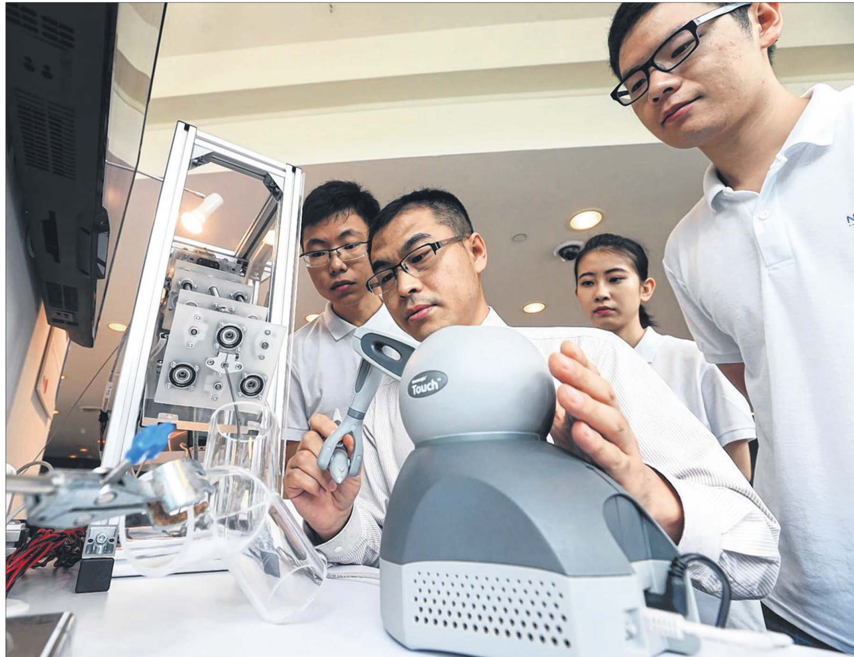
国大工程学院的任洪亮（左二）带领学生于海博（左一）、吴聊（右一）和武可雨（右二）设计并研发用于经鼻腔微创手术的遥操作连续型柔性套管机器人。（林国明摄）
