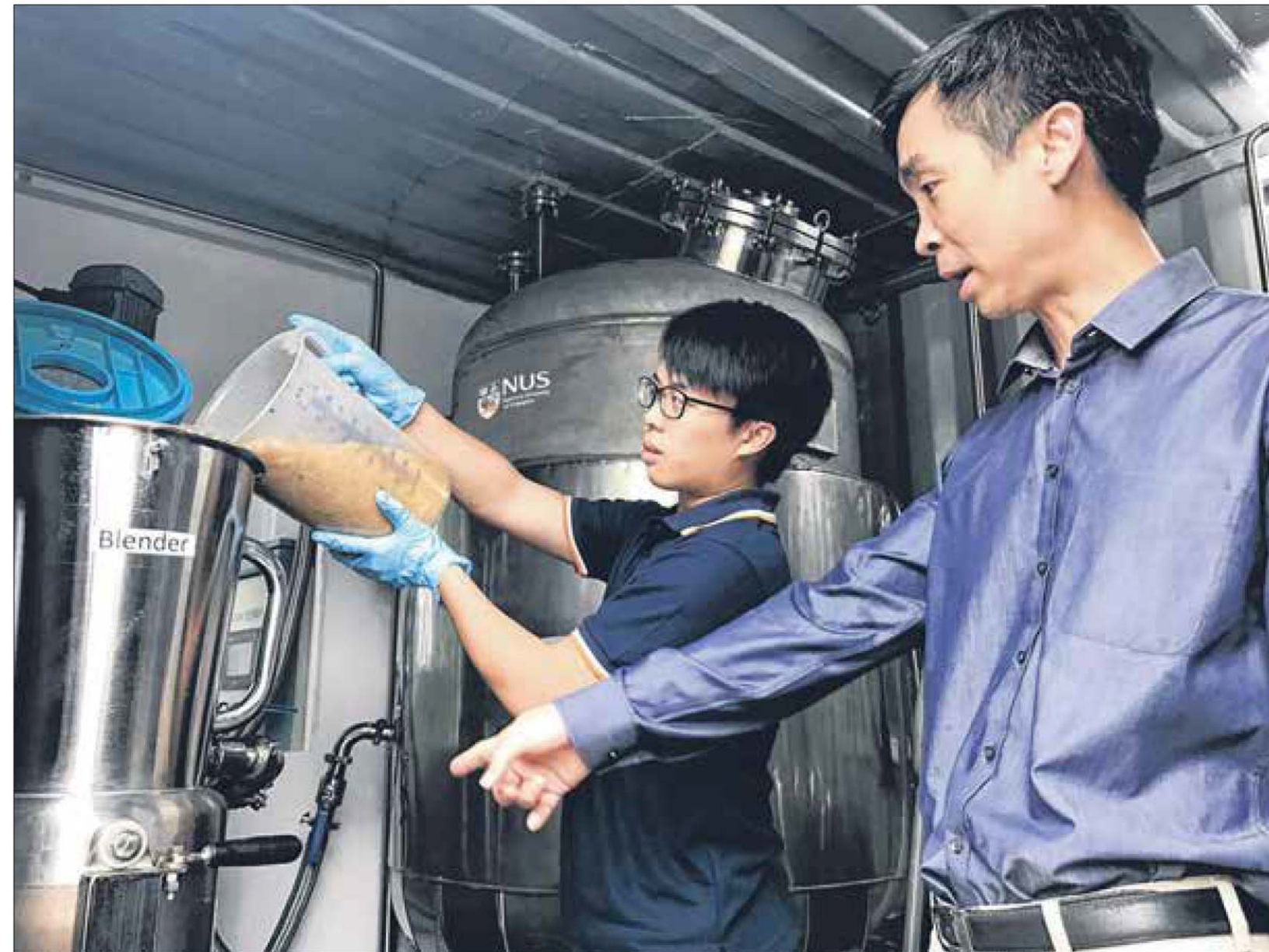
由新加坡国立大学和上海交通大学合作研发的厌氧分解系统，每天可处理近200公斤的食物垃圾。
